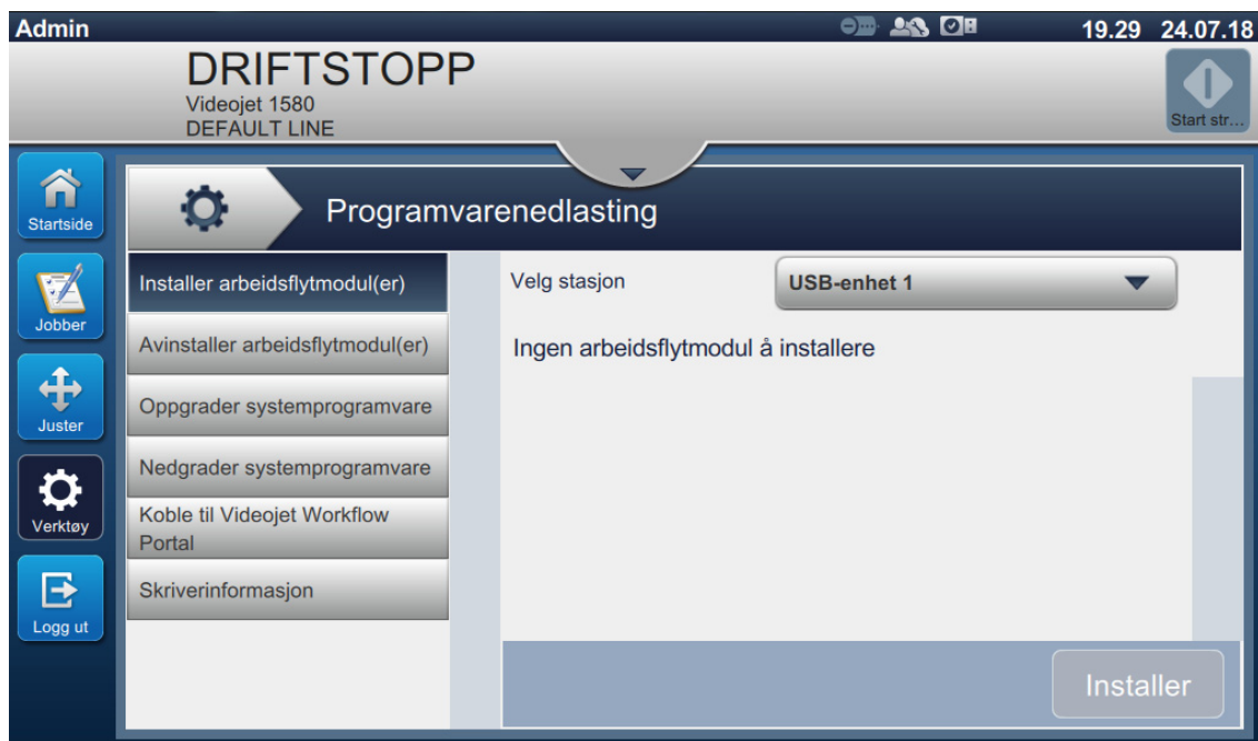
Figur 6-21: Skjermbilde for programvarenedlasting
