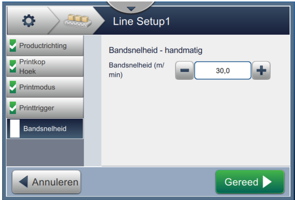
Afbeelding 6-34: Bandsnelheid - Handmatige instelling
