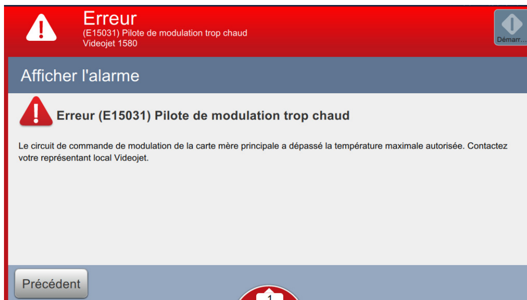
Figure 8-8 : Affichage des détails des anomalies
