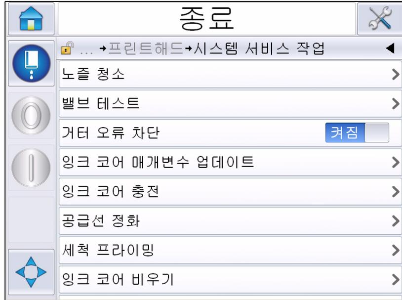
그림 4-24: 시스템 서비스 작업 메뉴
