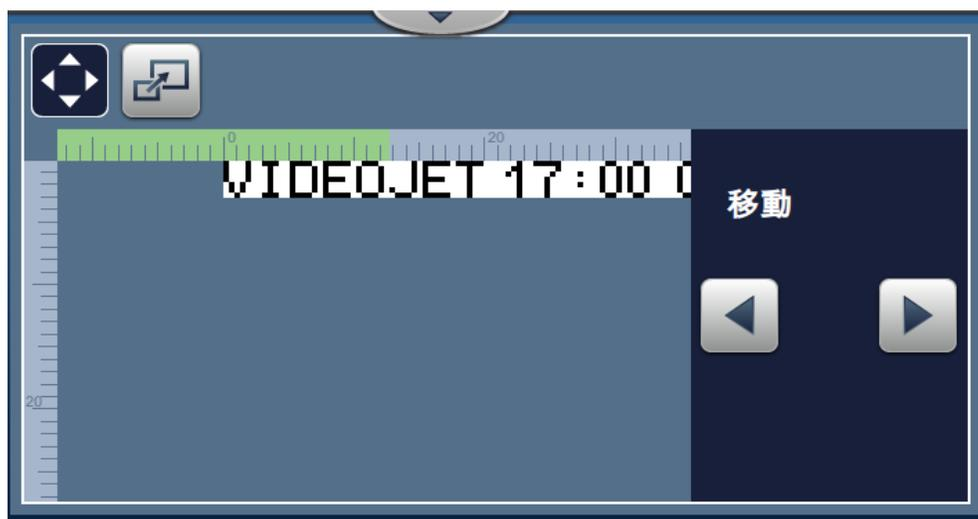
図 8-2: 印字位置の調整 - 移動
